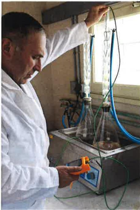
La solution fabriquée et utilisée par l'*Anelfa* est dosée à 1 % d'iode d'argent. Avec un débit de 1,1 litre par heure, la production de noyaux glaçogènes actifs à -15°C est de 200 milliards de particules par seconde.
