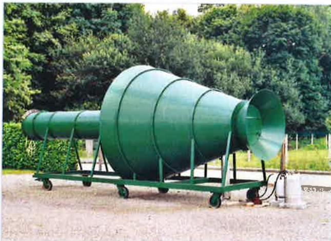
*Le tunnel à vent utilisé pour la mise au point des générateurs au Centre Technique de Lannemezan*
