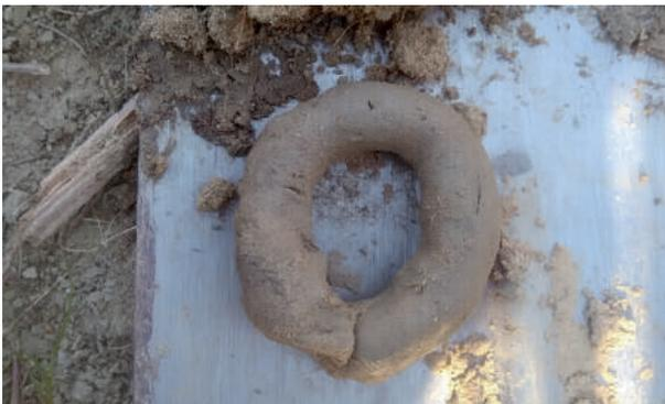
Le test du boudin permet également de se rendre compte de la sensibilité au lissage, de l'état de ressuyage du sol, de la sensibilité à l'érosion
