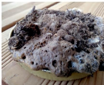
Test du carbone labile - formation de mousse et nombreuses bulles
