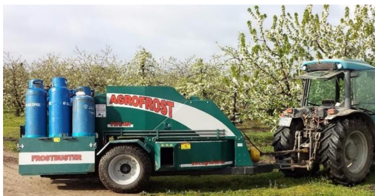
Dispositif Frost Buster à 2 sorties d'air basses – © AgroFrost
